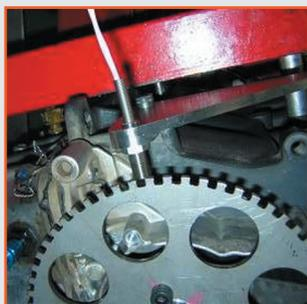
1. Vib360 calcule automatiquement les acyclismes, torsions et couples à partir de capteurs de vitesse magnétiques placés proche de cibles telles qu'une roue dentée.
